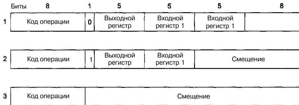
Рис. 5.16. Разработка форматов команд для трехадресной машины
