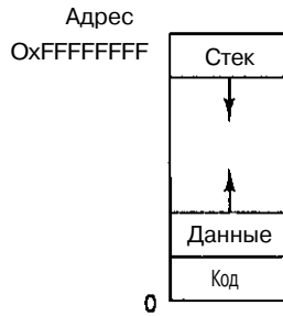
Рис. 6.26. Адресное пространство одного процесса UNIX
