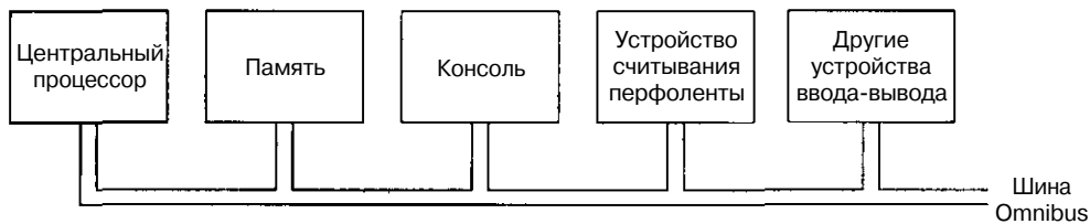
Рис. 1.5. Шина компьютера PDP-8
