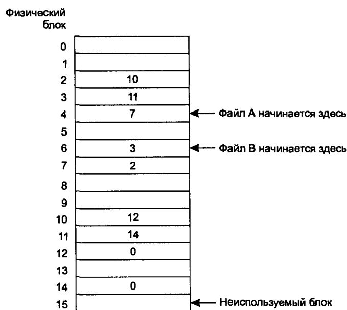
Рис. 5.7. Таблица размещения файлов
