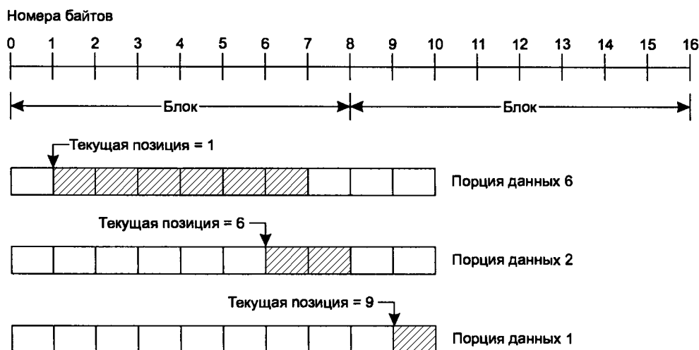
Рис. 5.31. Три примера того, как для 10-байтового файла определяется размер первой порции данных. Размер блока равен 8 байтам, запрашивается 6 байт. Порция отмечена штриховкой
