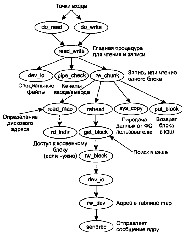
Рис. 5.32. Некоторые из процедур, участвующих в чтении файла
