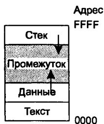
Рис. 1.9. Под процессы отводится три сегмента: текст, данные и стек
