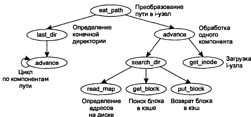
Рис. 5.34. Некоторые из процедур, участвующих в поиске файла по его пути
