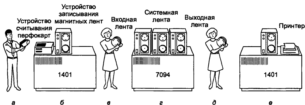
Рис. 1.2. Ранняя система пакетной обработки: а — программист приносит карты для IBM 1401; б — IBM 1401 записывает пакет заданий на магнитную ленту; в — оператор приносит входные данные на ленте к IBM 7094; г — IBM 7094 выполняет вычисления; д — оператор переносит ленту с выходными данными на IBM 1401; е — IBM 1401 печатает выходные данные
