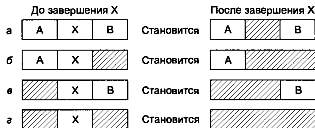
Рис. 4.6. Четыре комбинации соседства для завершения процесса X
