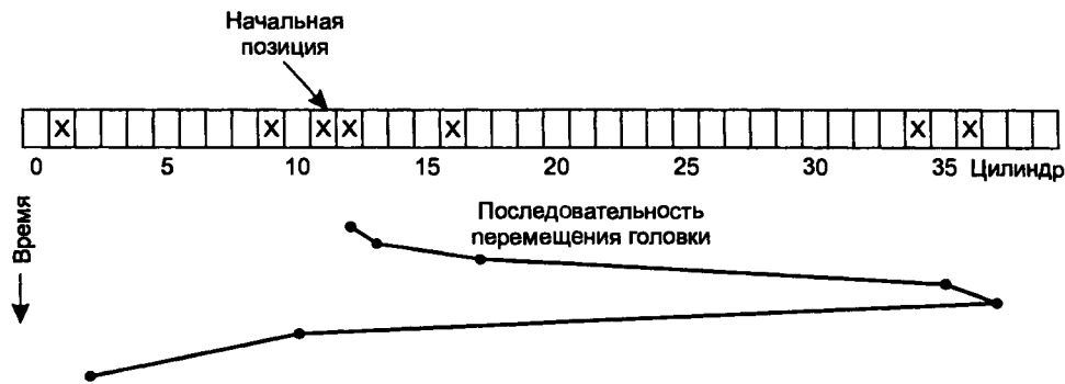
Рис. 3.14. Элеваторный алгоритм планирования обращений к диску
