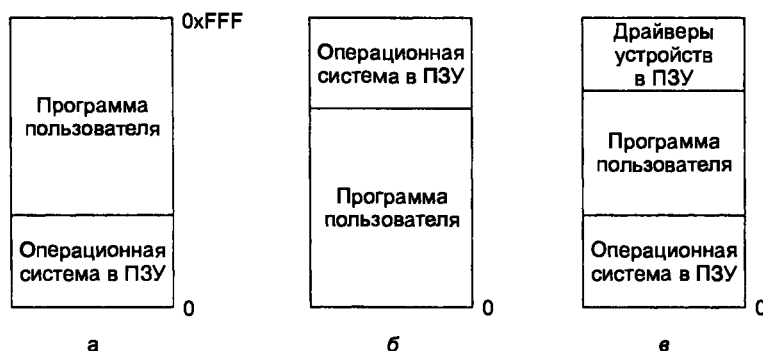
Рис. 4.1. Три простейшие модели организации памяти при наличии операционной системы и одного пользовательского процесса. Существуют также и другие возможные варианты
