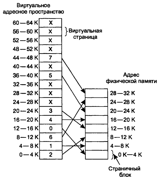
Рис. 4.8. Связь между виртуальными и физическими адресами, получаемая с помощью таблицы страниц
