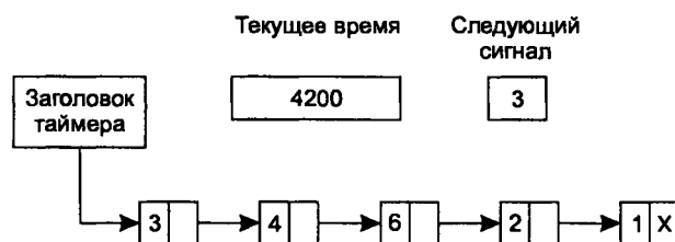
Рис. 3.17. Имитация нескольких таймеров на одних часах
